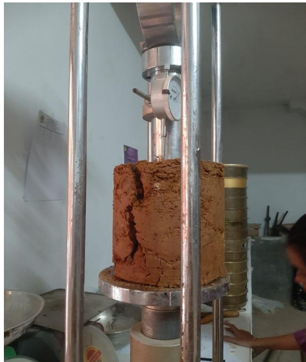
Kegiatan : Dari Keempat Sampel Tanah Pengujian Penetrasi Mengalami Keretakan Pada Penetrasi 5,08 mm/ 0,20 in
