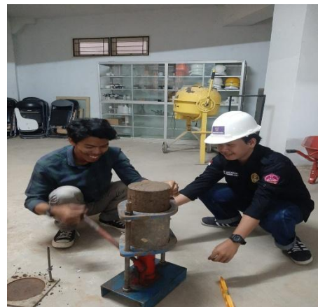
Kegiatan : Pengeluaran Sampel Tanah Menggunakan Dongkrak
