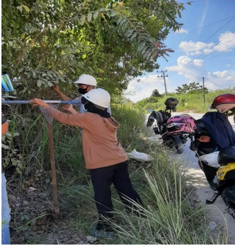
Kegiatan : Pengambilan Sampel Tanah di Lapangan Untuk Uji CBR
