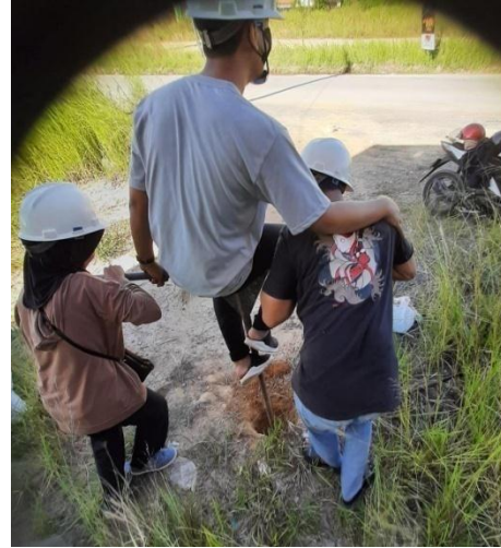
Kegiatan : Pengambilan Sampel Tanah di Lapangan Untuk Uji CBR
