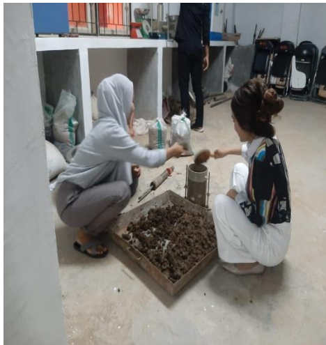
Kegiatan : Memasukkan Tanah Ke Dalam Cetakan Sekaligus Penumbukan
