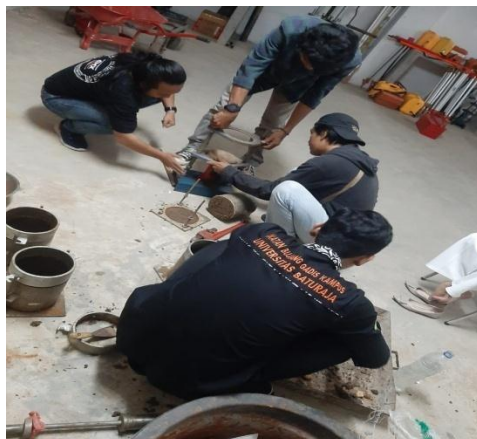
Kegiatan : Pengeluaran Sampel Tanah Menggunakan Dongkrak
