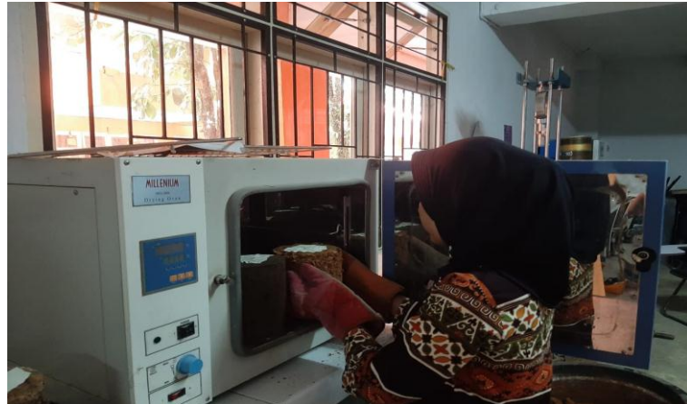
Kegiatan : Keluarkan Sampel Tanah Setelah di Open Selama 1x 24 Jam
