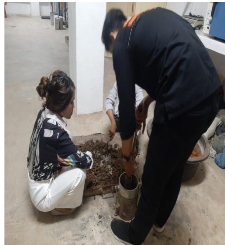
Kegiatan : Memasukkan Tanah Ke Dalam Cetakan Sekaligus Penumbukan
