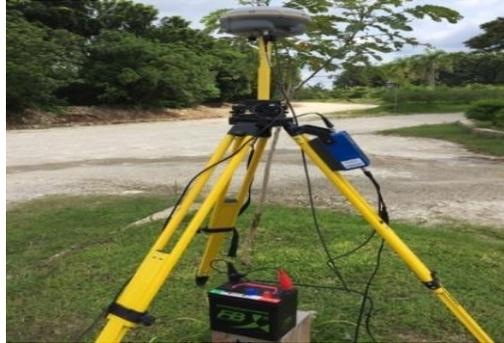
Gambar 2.11 *Base GPS Geodetik Trimble R8SLT*
