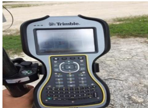
Gambar 2.17 *Controller GPS* Geodetik
