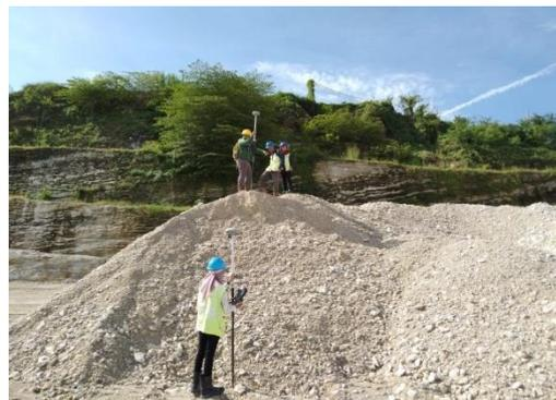
Gambar 2.10 Pengambilan Data Menggunakan *GPS* Geodetik Trimble R8SLT.
