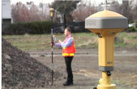
Gambar 2.9 Receiver Tipe Geodetic dari Topcon
