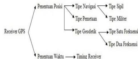
Gambar 2.6 Skema Pembagian Klasifikasi *Receiver GNSS*.
