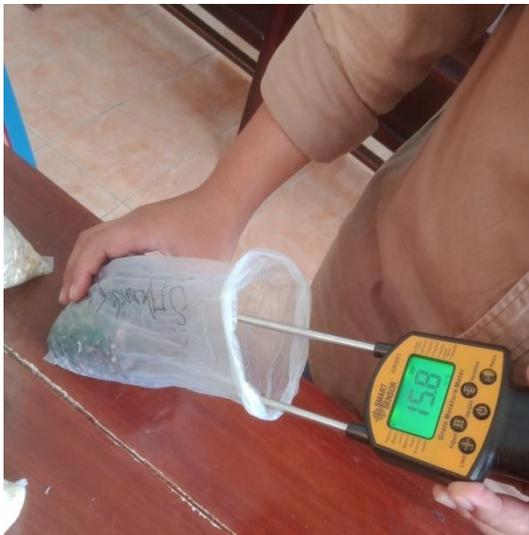
Gambar 15. Pengukuran Kadar Air pada Biji Jagung
