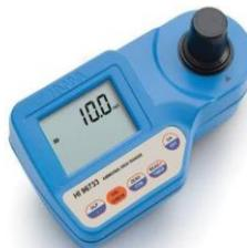
***Gambar 2. 7 Alat untuk mengukur Nitrat***
