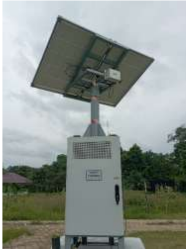
Gambar 1. 5 Alat sensor unsur hara dalam tanah berbasis IoT
