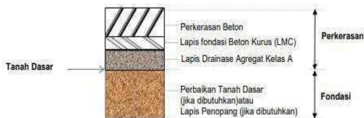
Gambar 2.2.4 Struktur perkerasan kaku pada timbunan
