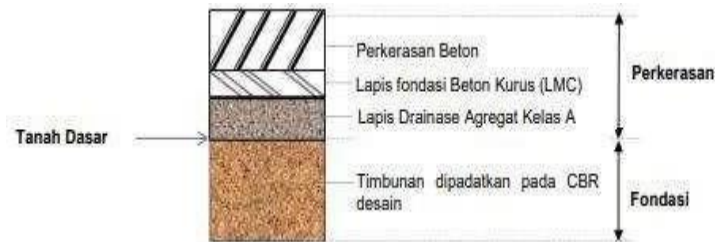
Gambar 2.2.5 Struktur Perkerasan kaku Pada Galian
