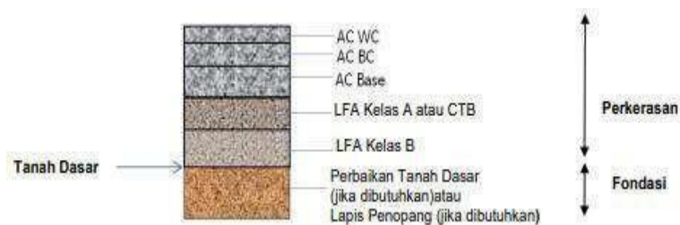
Gambar 2.2.3. Struktur perkerasan (Lalu Lintas Berat) pada Galian
