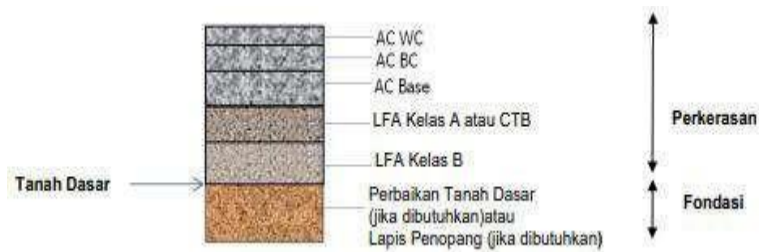
Gambar 2.2.3. Struktur perkerasan (Lalu Lintas Berat) pada Galian
