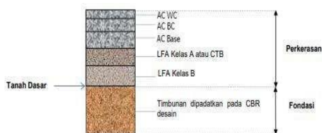
Gambar 2.2.2 Struktur Perkerasan (Lalu Lintas Berat) pada timbunan
