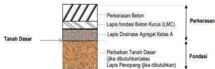
Gambar 2.2.4 Struktur perkerasan kaku pada timbunan
